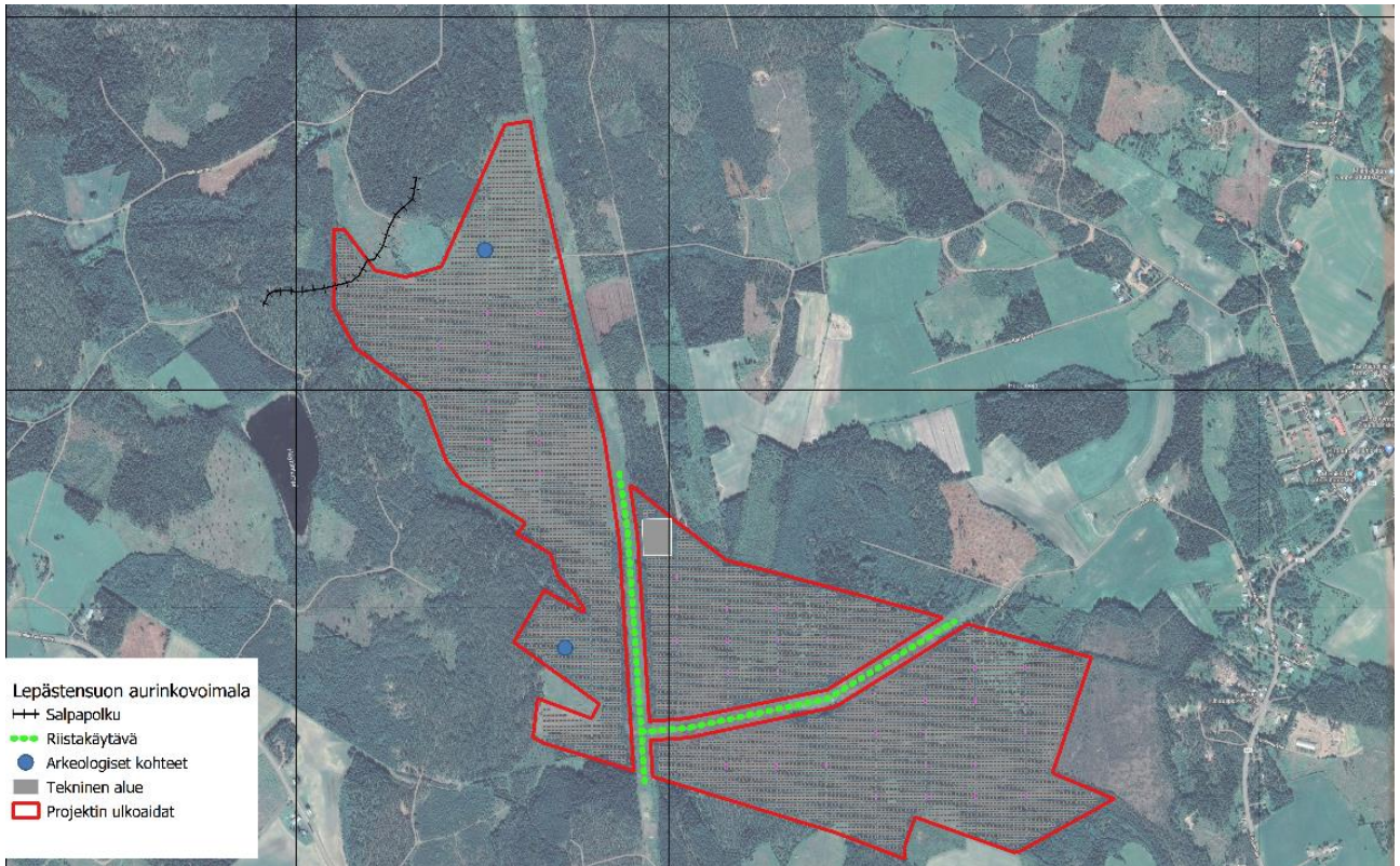
Kuva 3-3. Paneelienttien alustavat sijainnit. Voimalinjat jakavat aidattavat alueet kolmeen erilliseen osaan. Lähde: Forus Oy 2023c.
